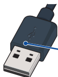
リバーシブルタイプ USB コネクター (接点基板が中央にある)
