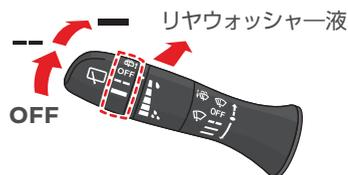
スイッチを車両前方に押すとリヤウォッシャー液が噴射し、ワイパーが数回作動します。
