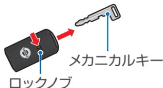
**2** メカニカルキーを鍵穴に差し込み、車両前方に回すと施錠します。車両後方に回すと解錠します。
