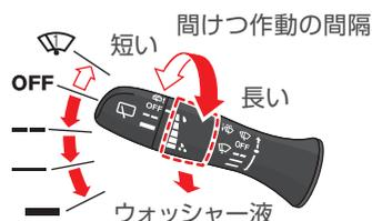
スイッチを手前に引くとフロントウォッシャー液が噴射し、ワイパーが数回作動します。
