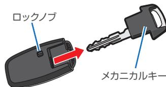
**2** メカニカルキーを鍵穴に差し込み、車両前方に回すと施錠します。車両後方に回すと解錠します。
