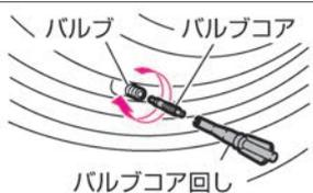
7 注入が終わった空ボトルから修理剤が漏れるのを防ぐため、注入ホースの先端にバルブコア回しを差し込んで栓をします。
