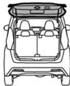
2 リヤコンビランプのボルトを外し、ランプをまっすぐ後方に引いて取り外します。
