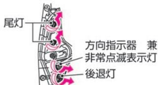
4 古い電球を引き抜き、新しい電球をソケットに取り付けます。
