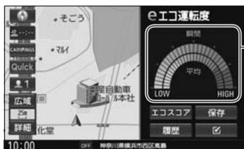
車の速度・加速度などから計算されたエコ運転度(メーターを参考にして運転することで、エコ運転の向上が期待できます。)
