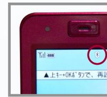
Bluetoothが「On」になっていることを確認します。OFFになっている場合は、[B.携帯電話の登録]又は[D.BluetoothのOn/Offの方法]を参照しOnにして下さい。
